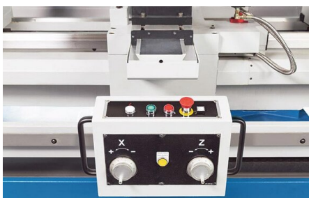
Kompaktní obslužná jednotka s elektronickými ručními kolečky
